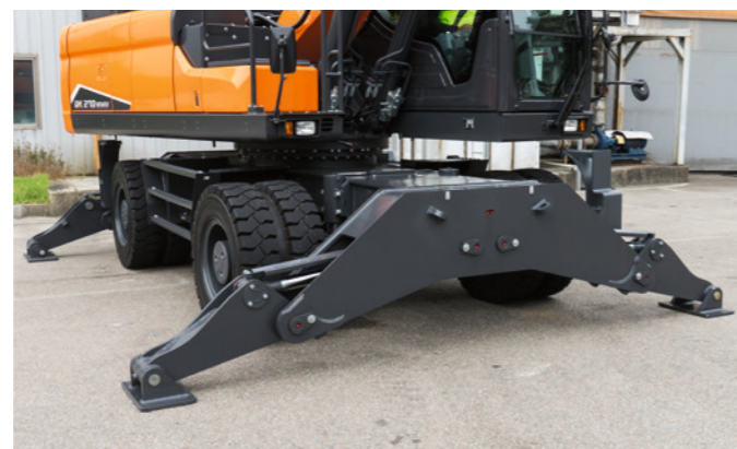
Specjalnie zaprojektowane podwozie z szerokimi podporami dającymi większą stabilność
