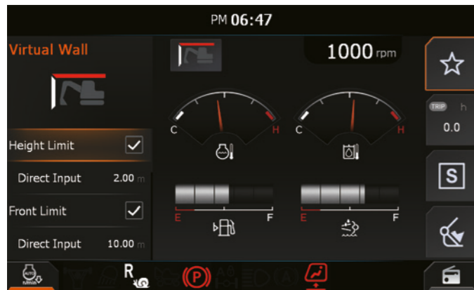
System wirtualnych ścian pozwala na bezpieczną pracę w budynkach
